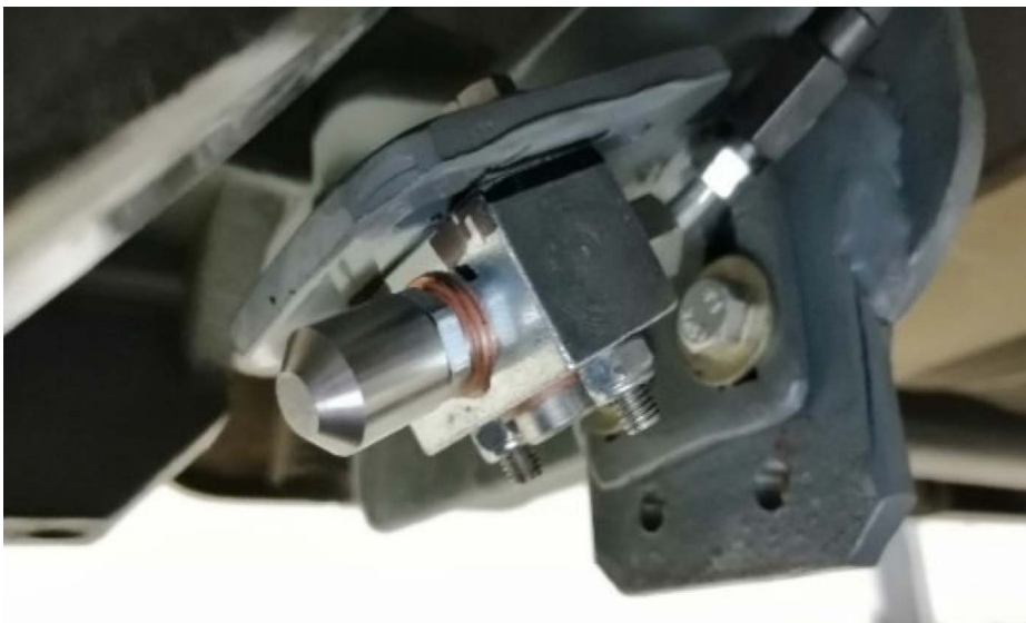
Sproeikop voor wrijvingsbeheer bovenzijde rail en/of smering flens
